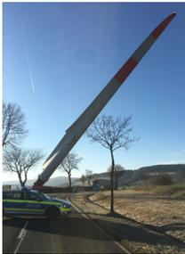
Freitag, 6. Januar 2017 – **Wegensen (wbn)**. Dieser Schwertransport, der in den vergangenen Tagen durchs Weserbergland rollte, ist etwas ganz besonderes: Das verladene 50 Meter Rotorblatt lässt sich auf dem Schwertransport bis zu 47 Meter in die Höhe aufrichten und kann sich zusätzlich um die eigene Achse drehen.
